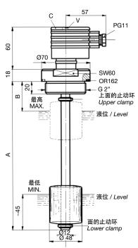
液位传感器SLM1FA ... CVS1和SLM2FA ... CVS1,SLM1TA ... CVS1和SLM2TA ... CVS1配备有4/20 mA信号转换器装在C接头中,旨在连续检查罐中液体的液位。
