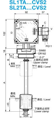
液位传感器SL1FA...CVS2和SL2FA...CVS2, SL1TA...CVS2和SL2TA...配备有4/20 mA信号转换器装在C接头中, 旨在连续检查罐中液体的液位。
